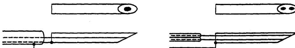
Figur 21 EMG-elektroder. a: koncentrisk, b: bipolar
